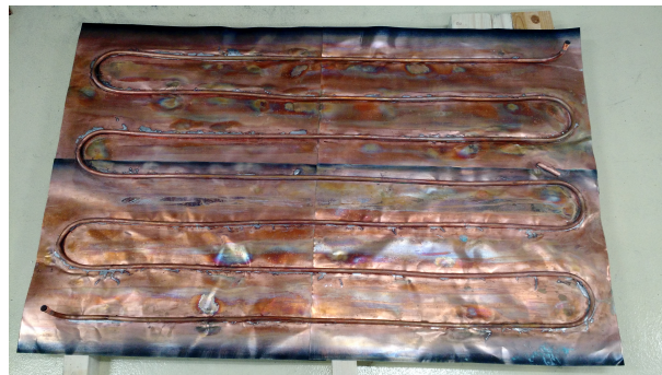
FIGURE 18 – Un des 3 absorbeurs de chaleur
