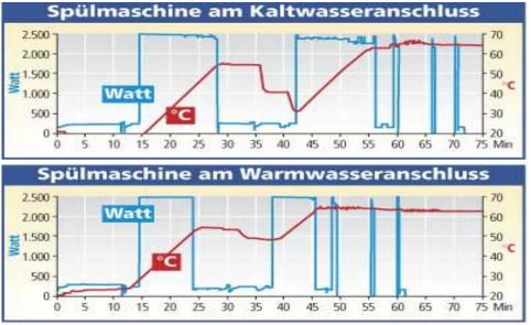
Spülmaschine MIele G575, Universalprogramm 55°C, Warmwassererzeugung über neue Gastherme, maximale Temperatur eingestellt, 12 mm Kupferrohr 4 m von Therme bis Anschluss, ohne Warmwasserzirkulation.
